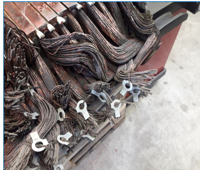
Durch Pyrolyse freigebrannte Kupferwicklungen
