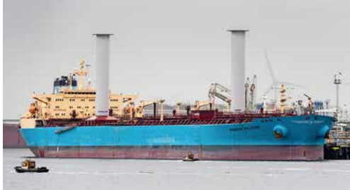
Ein modernes Schiff mit Flettnerrotor von Norsepower
