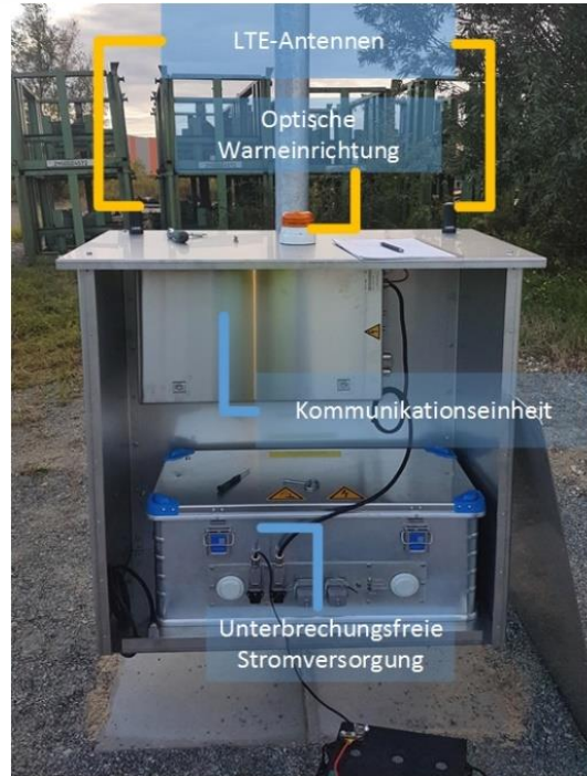
Warneinrichtung-geöffnet (Quelle: Hunwardsen)
