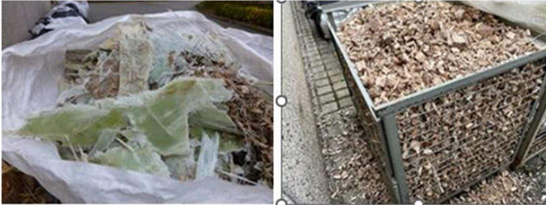
Das Sandwich-Laminat wird zerkleinert und durch Schwimm Sinkverfahren getrennt. Reines Balsa oder Schaum kann für weitere Anwendungen wie Isolationsmaterial für Bauanwendungen verwendet werden
