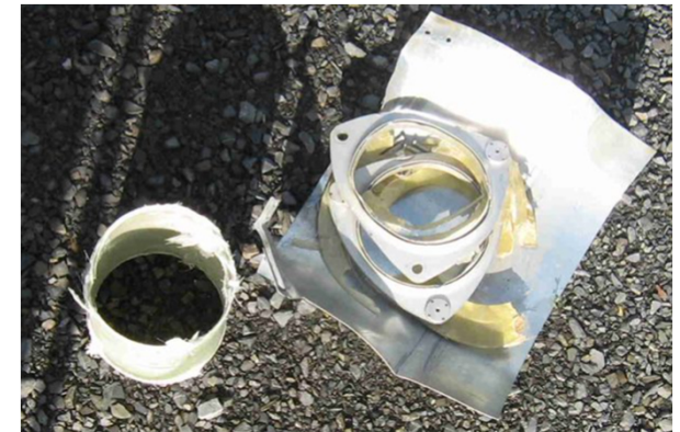
Defekte Kupplung zerstörte Azimuthmotor
