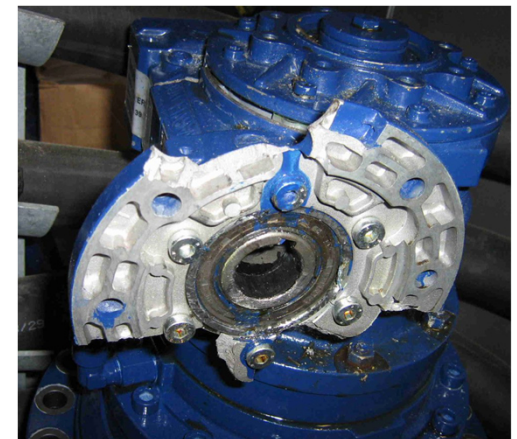
Defekte Kupplung zerstörte Azimuthmotor
