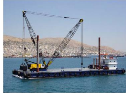
b) Crane barge
