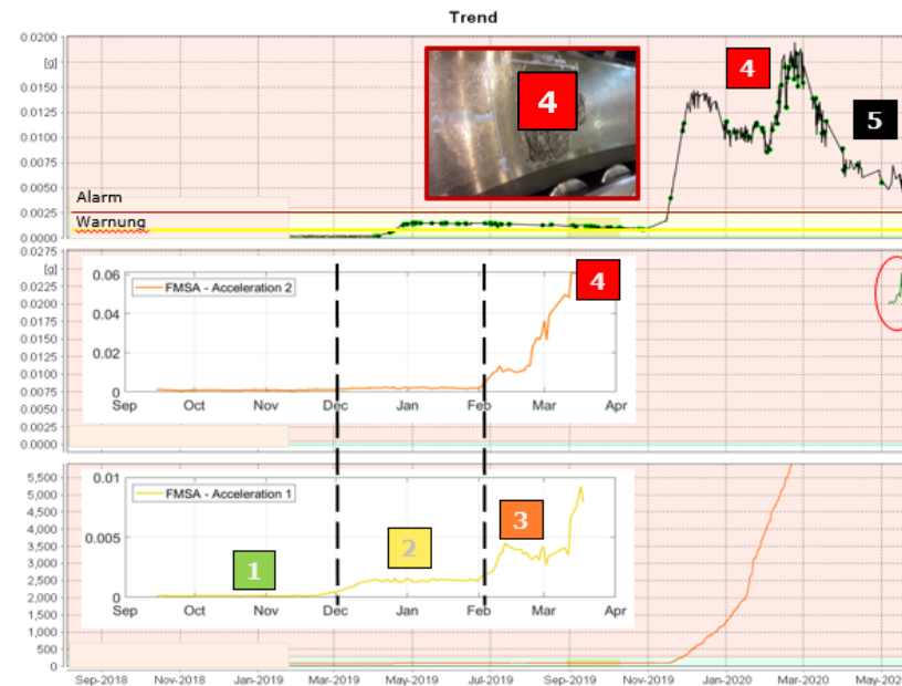
Trendverlauf eines Hauptlagerschadens
