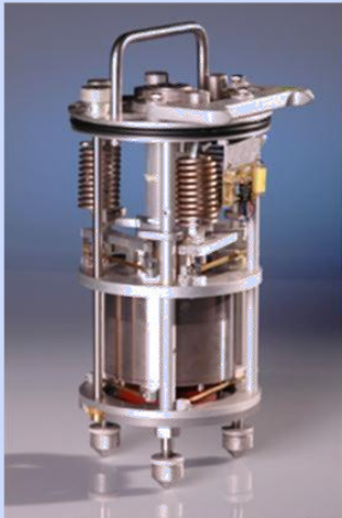
Innenansicht eines Seismometers Quelle: BGR
